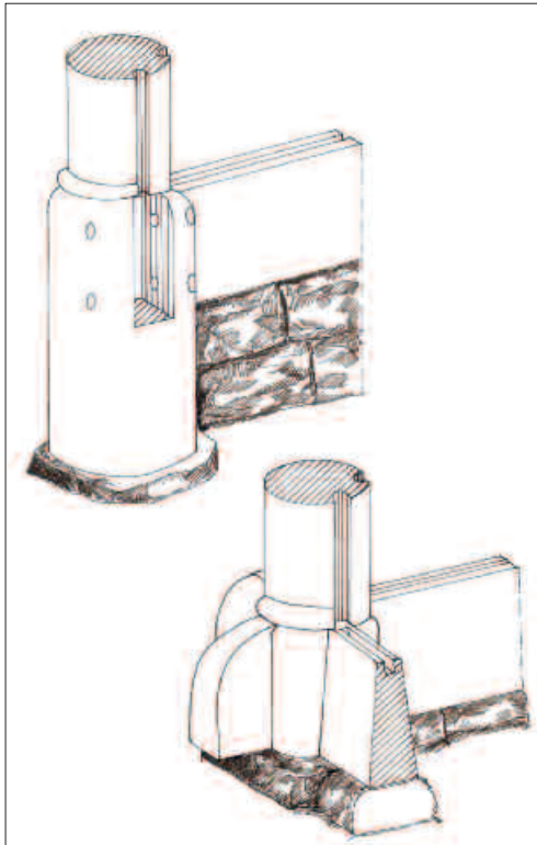
Figur 7 To løsninger av hjørnestaver, i prinsipp. Tegning: J. H. Jensenius 2008.
